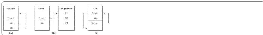
Abb. 21. (a) Stack Maschine (keine ext. Abhängigkeit) (b) Register Maschine (c) Speichermaschine
